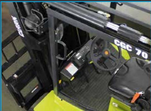
L'intérieur du poste de conduite généreusement conçu offre au conducteur suffisamment d'espace pour la tête et les jambes. Le conducteur peut entrer et sortir confortablement par une grande marche. Les poignées des deux côtés du chariot augmentent la sécurité. La colonne de direction est inclinable et peut être réglée individuellement.
