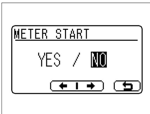
Étape 4 Lorsque le contacteur (2) est enfoncé, appuyer sur le contacteur (3) pour remplacer NO par YES à l'écran et finaliser le paramétrage.
