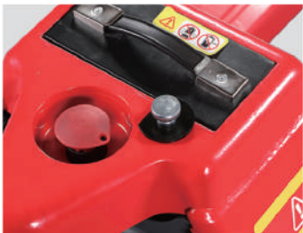
Loquet rotatif de maintien de la batterie
