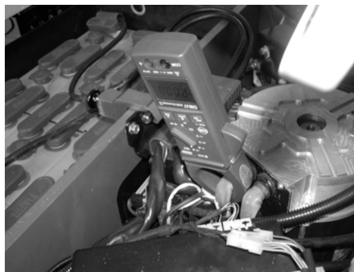
Méthode de mesure, procédure avec pince ampèremétrique
