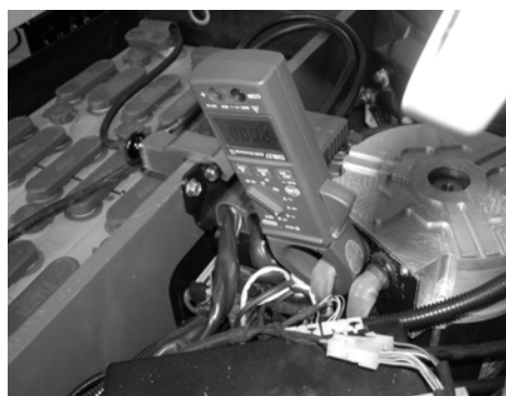
Méthode de mesure, procédure avec un ampèremètre à borne
