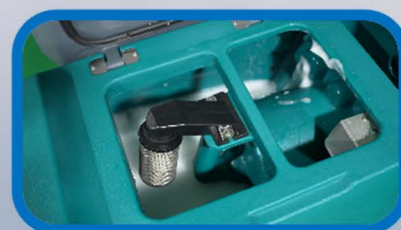
Grand Réservoir D'Eaux Usées
